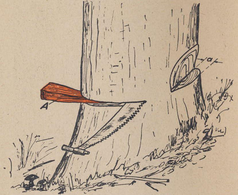
Ankerben und Sicherung mit Keil beim Ansägen eines Baumstammes.
