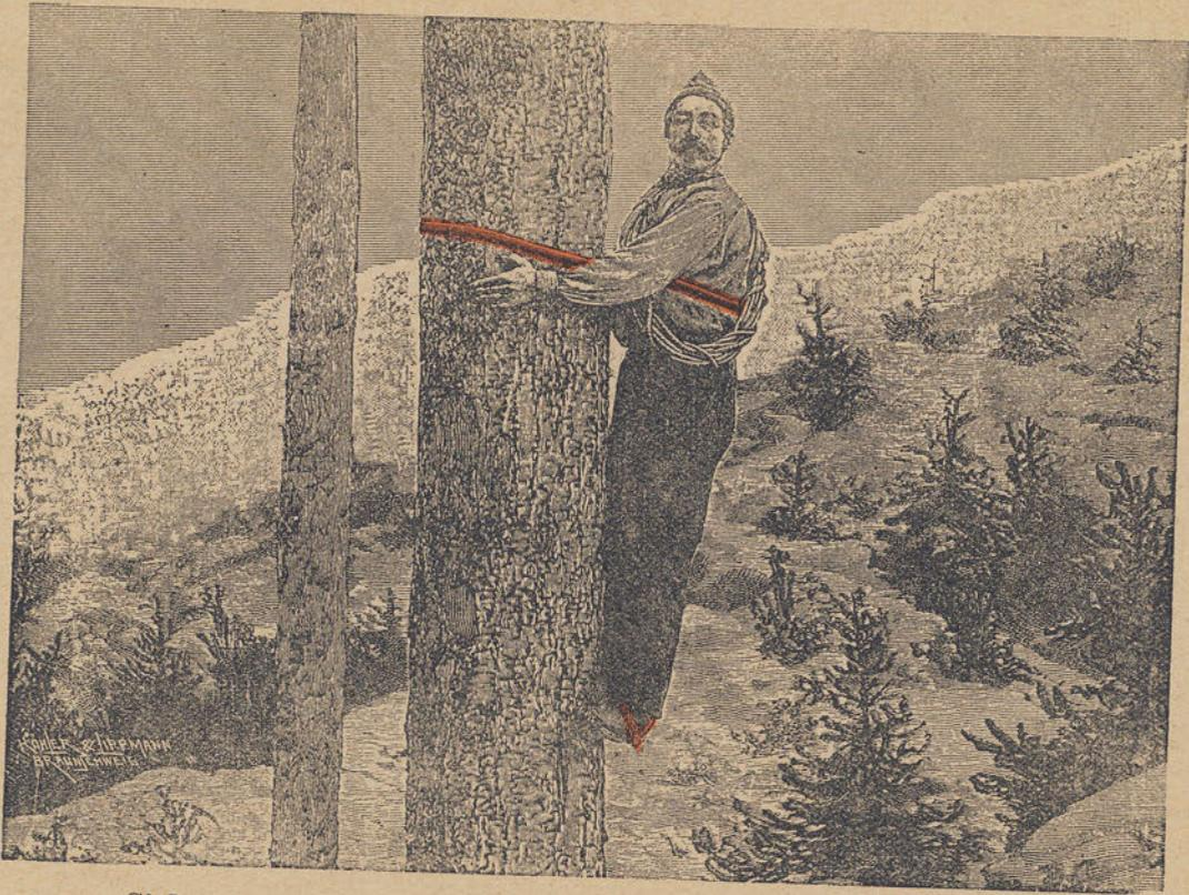
Sicherung beim Besteigen eines Baumes durch Sicherheitsseil und Steigeisen (am Fuß angeschnallt).
